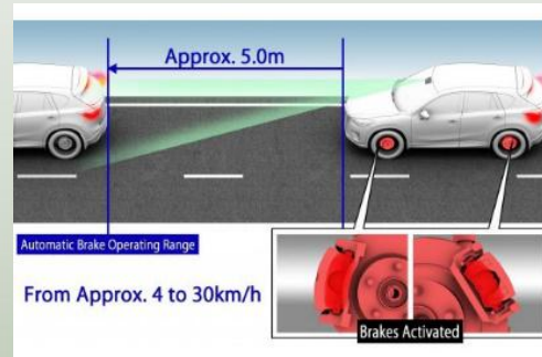
AEB/自动紧急刹车系统 (Autonomous Emergency Brake)
