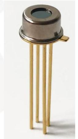
4、响应率（灵敏度），表征入射的光功率转换为输出电压的值。
