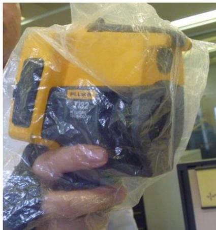
将塑料薄膜套在热像仪上进行检测
