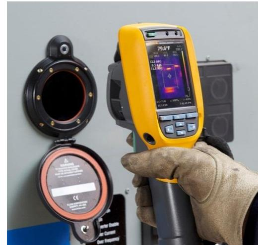
Fluke标准红外窗口产品是为了中高压电气柜而设计，不能用于有正/负压的现场。
