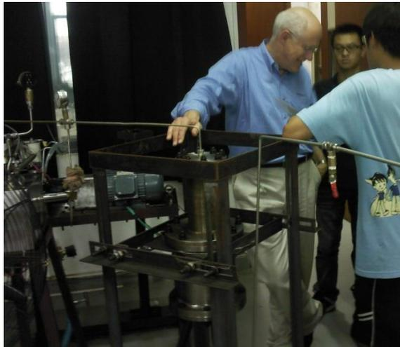
模拟汽车内燃发动机的真空炉设备
