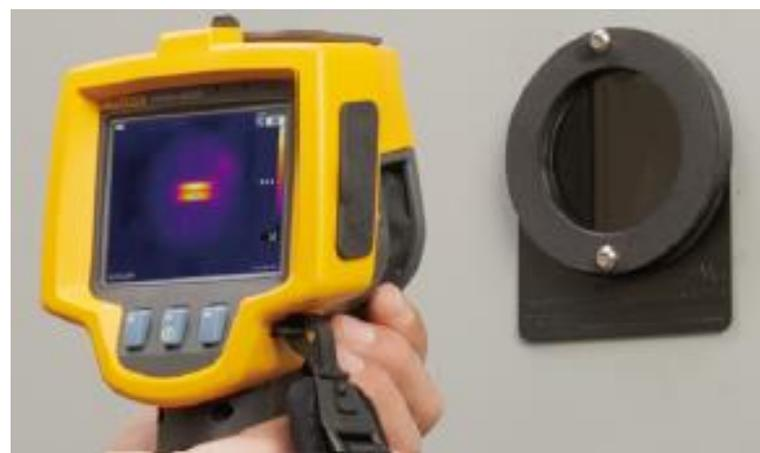
红外窗口安装在电气柜柜门上，热像仪可透过窗口检测内部设备
