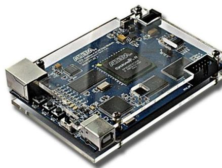
**Cyclone II FPGA核心板**
