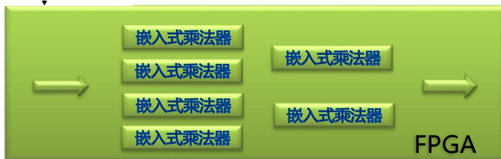
FPGA的分布式的并行处理比基于软件的串行处理速度要大大提升。在电信、网络、多媒体等方面的应用有明显的优势
